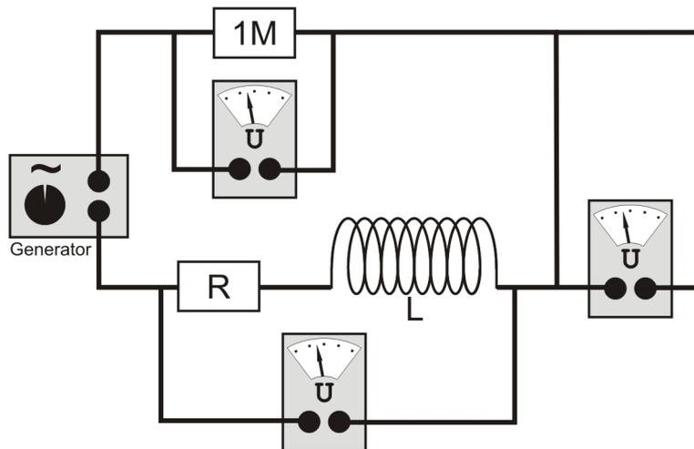
Abb.5: Schaltung zur Bestimmung von Induktivität und Verlustwiderstand eine Spule
