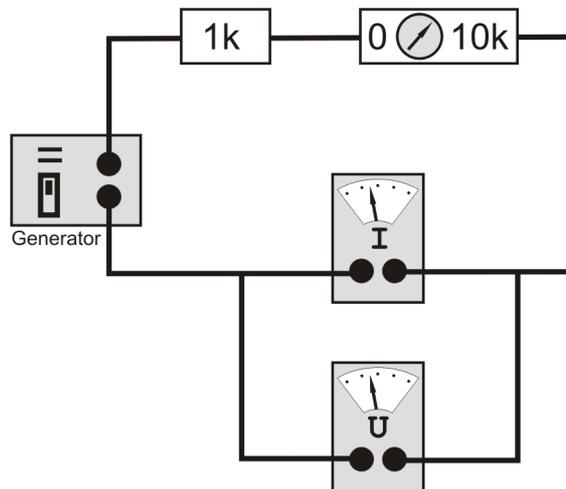
Abb.1: Bestimmung Innenwiderstand des Messgeräts
