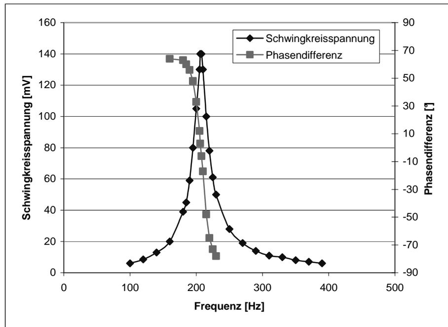
Wir konnten an der Spannungsquelle  $U_0 = 8,7V$  messen und ermittelten die Resonanzfrequenz  $\omega_0 = 207Hz$  anhand von Schaubild und Betrachtung der Messwerte.
