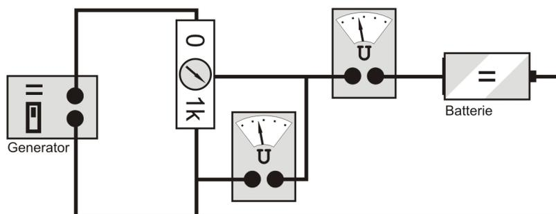
Abb.4: Kompensationsschaltung zur Batteriespannungsbestimmung
