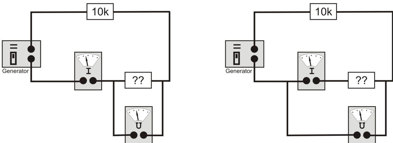
Abb.2: Links a) spannungsrichtige, rechts b) stromrichtige Schaltung
