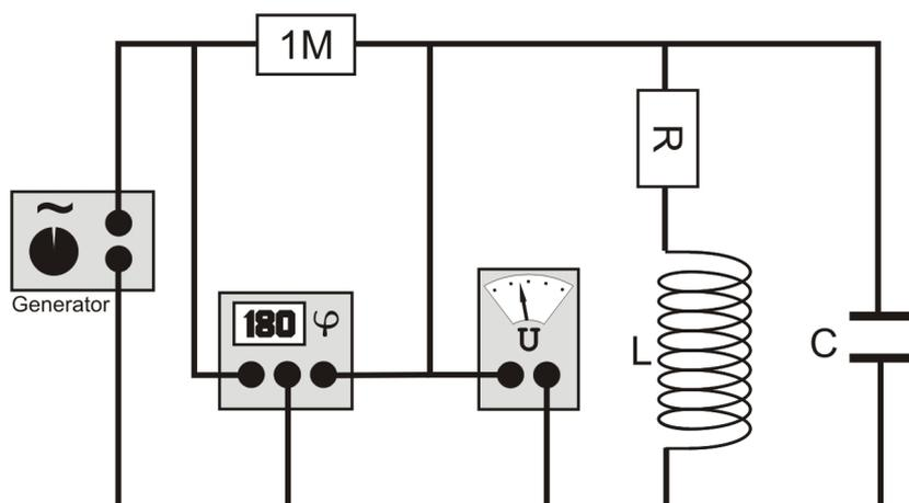
Abb.6: Parallelschwingkreis mit Phasendifferenzmessgerät und Spannungsmessgerät
