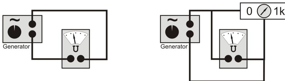
Abb.8: Messung von Spannung am Sinusgenerator im unbelasteten und belasteten Zustand
