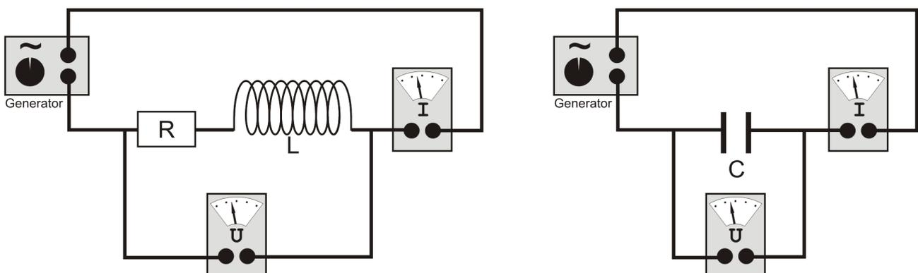
Abb.7: Messung von Strom und Spannung bei Spule und Kondensator
