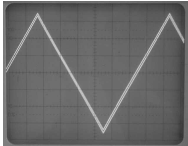
Abb.11: T \ll RC (t: 5\mu s/cm CHI: 0,2V/cm CHII: 0,2V/cm )
